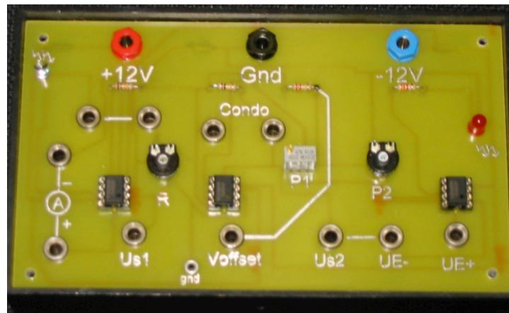
**Figure 2** : Circuit d'allumage automatique des phares d'une automobile en cas d'obscurité :
